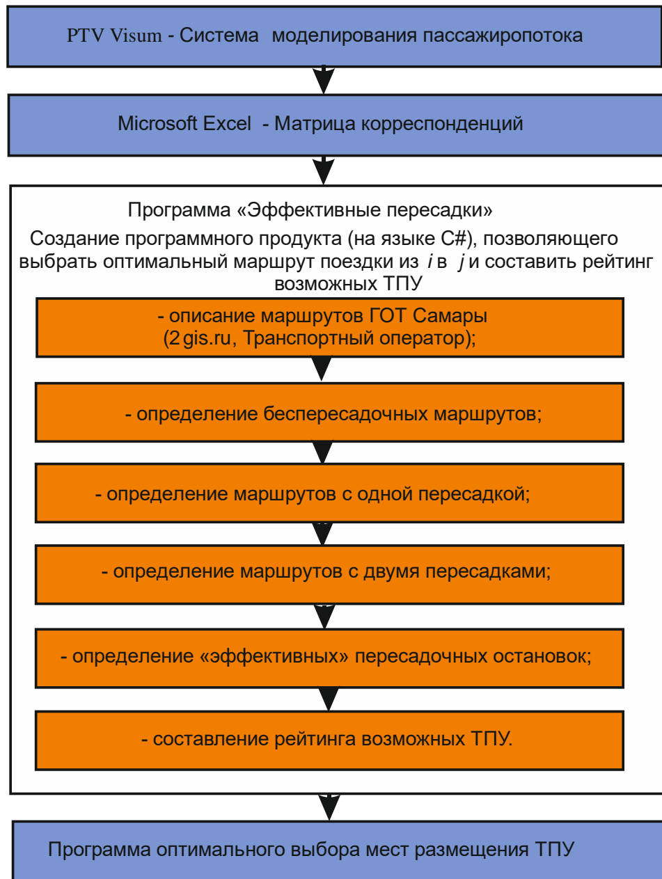
Рисунок 4.1 – Программные продукты, используемые для определения количества и мест размещения транспортно-пересадочных узлов
